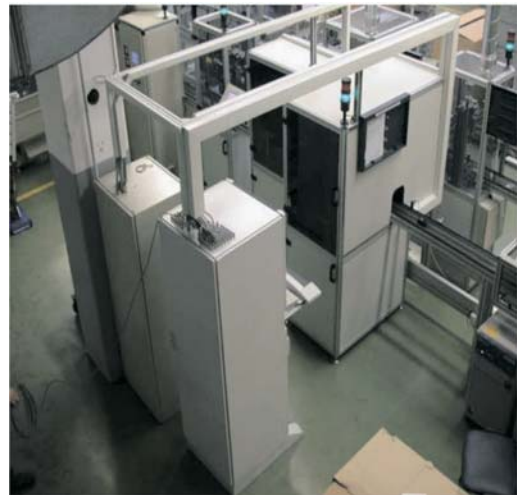
Diagnostična celica za kontrolo kakovosti sesalnih enot na proizvodni liniji (Avtor posnetka: J. Petrovčič)
