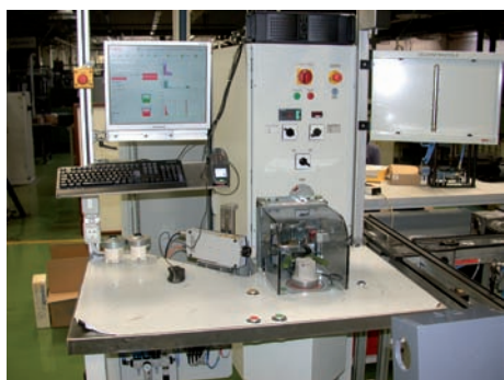
Slika 3: Diagnostični sistem za končno kontrolo elektromotorjev na novi proizvodni liniji ekomotorjev v Domelu
