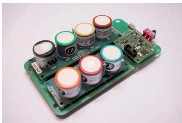
Slika 1: Merilnik kakovosti zraka, zasnovan na platformi VESNA
