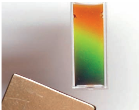
Slika 2: Če stabilno suspenzijo superparamagnetnih nanoskupkov približamo magnetu, se v njej vzpostavi periodična struktura, katere perioda je primerljiva s dolžino vidne svetlobe. Periodičnost strukture se spreminja z jakostjo magnetnega polja, s tem pa barva svetlobe, ki jo suspenzija sipa.
