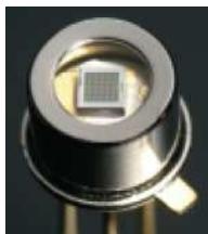
Slika 5: Primer silicijeve fotopomnoževalke (Hamamatsu S10362-11-050U) [2].
