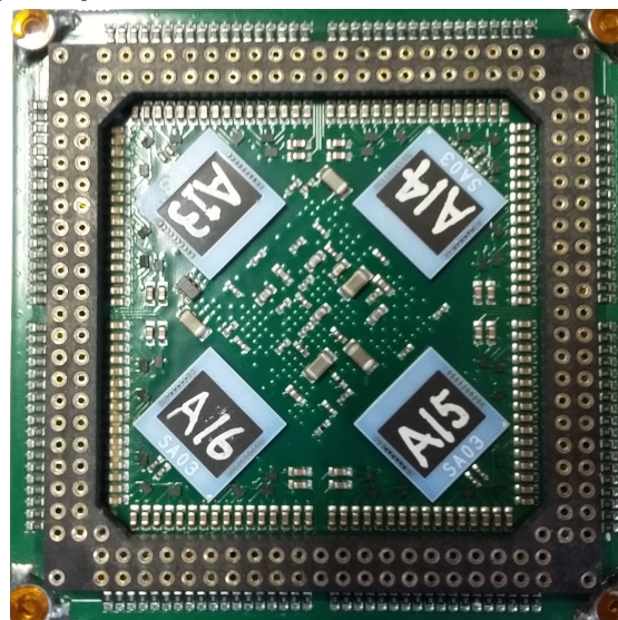
(b) Sprednja stran čitalne elektronike s štirimi čipi ASIC.
