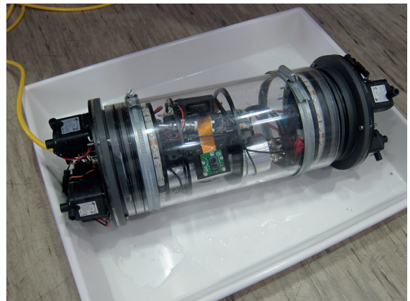
Podmorniški robot, ki bo preiskal bližino poškodovanih reaktorskih sredic v Fukušimi.
