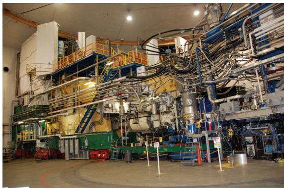
Slika 2. Eksperimentalna dvorana A v laboratoriju TJNAF, kjer smo izvedli meritev kršitve parnosti. Žarek elektronov iz pospeševalnika CEBAF vstopi v halo z desne in zadene kriogensko devterijevo tarčo na sredini. Sipane elektrone zaznamo z magnetnima spektrometroma z visoko ločljivostjo, od katerih je eden viden na levem delu fotografije, drugi pa je delno viden iz ozadja. Vir: TJNAF.
