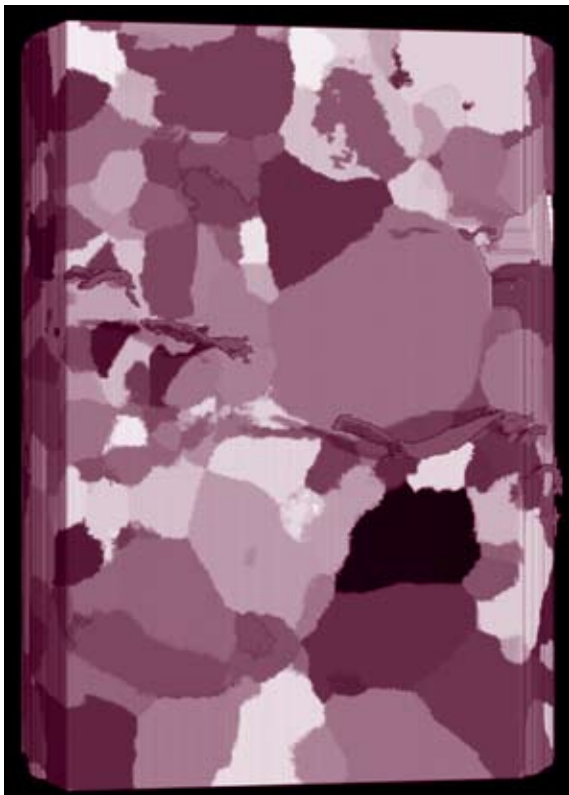
Slika 1: Vizualizacija dela kristalnih zrn žice iz avstenitnega nerjavnega jekla s premerom 0,4 mm (King s sodelavci). Število vseh zrn v vzorcu je 362, povprečna velikost kristalnega zrna je 50 \mu\text{m} , število povsem opredeljenih kristalnih mej presega 1600. Živordeče površine v po višini srednjem delu slike so prostorska slika mreže medkristalnih razpok.
