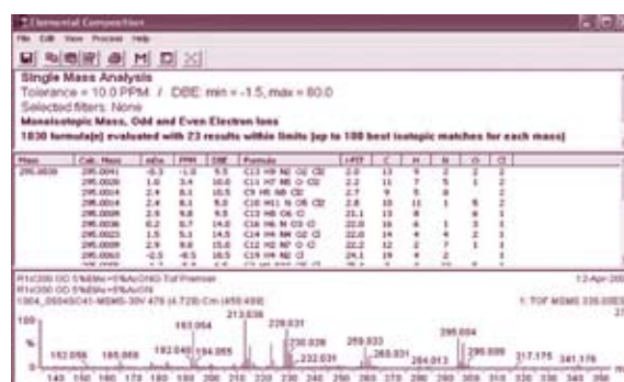
Slika 2. Primer masne meritve: elementna sestava in masni spekter razgradnega produkta farmacevtskih učinkovin v odpadnih vodah, izmerjen z novim masnim spektrometrom Q-ToF Premier
