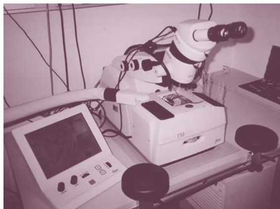
SLIKA 1. V krioultramikrotomu režemo ultratanke rezine zamrznjenih celic (posneto na EMBL, Heidelberg).
