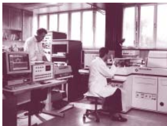
Visokoločljivostni tandemski masni spektrometer AutospecQ leta 1991
