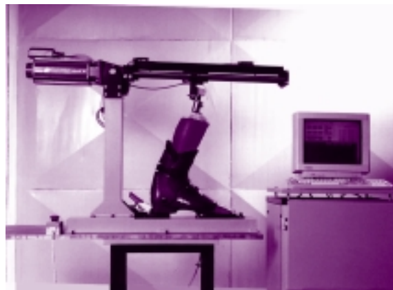
Slika 5: Robotizirana naprava za preskušanje smučarskih čevljev
