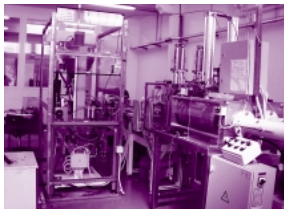
Slika 4: Avtomatska linija za izdelavo negativnih elektrod
